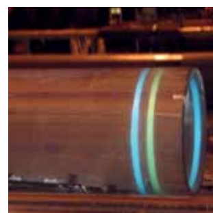
Marcado de anillos coloreados en tubos de acero
