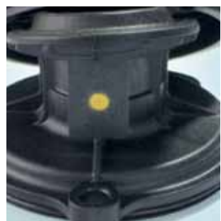
Marcado de piezas aprobadas tras inspección
